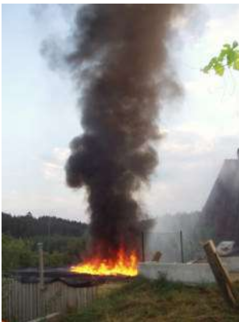
Image 17: La membrane se consume sur l'isolant
