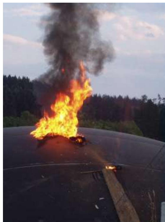
Image 10 + 11: 6. Un chiffon imbibé d'essence, enflammé, est jeté sur la membrane de stockage
